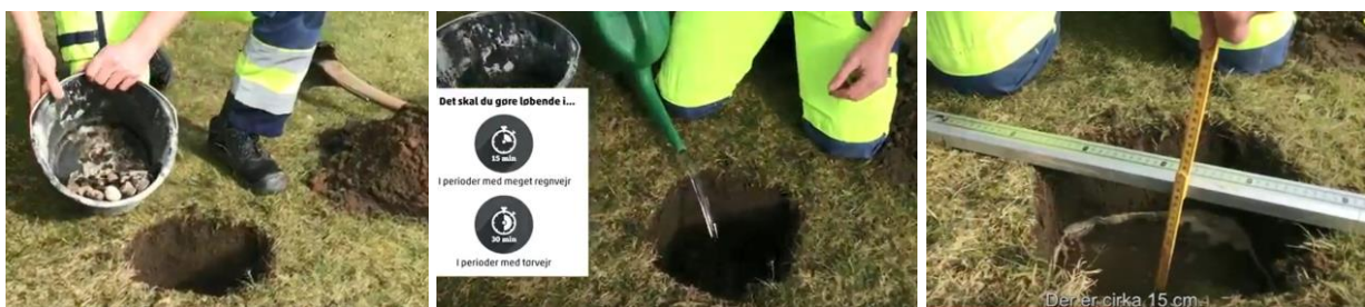
Figur 2: Viser tre steps af infiltrationstesten vha. nedsivningshul. Først graves hullet, der puttes grus eller sand i bunden (første billede). Hullet fyldes med vand og jorden opfugtes (anden billede). Til sidst måles dybden på vandspejlet som måles igen efter 10 min (tredje billede). Kilde (Arwos, u.d.)
